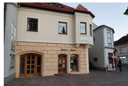
3. Vhodné označenie prevádzky zo samostatných písmen v neutrálnej farebnosti umiestnené osovo nad vstup a výklad prevádzky.
